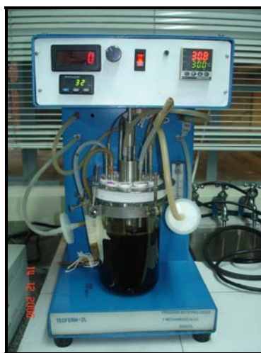
Figura 12. Montaje de biorreactor 1.5L. Medio melaza 20% (p/v), 37°C, 150rpm, 1vvm. Fuente: Autores.
