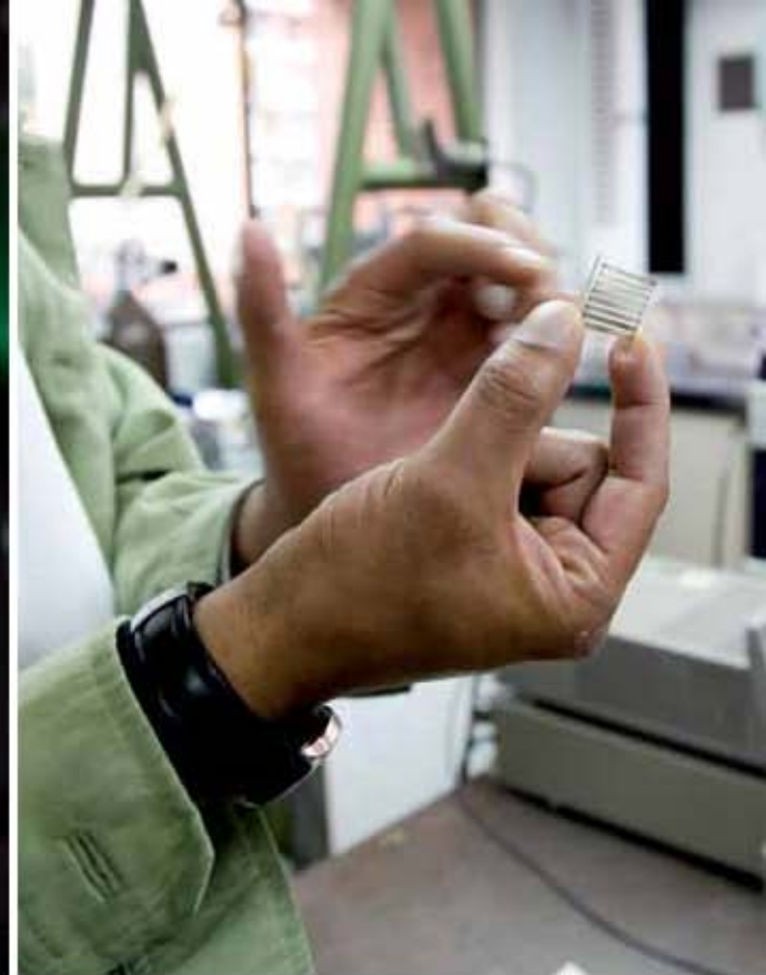
FOTOGRAFÍA DE GUILLERMO SANTOS. Sustrato con contactos prepatronados para la fabricación de un display QLED de 64 píxeles.
