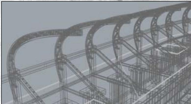
También se ven los diferentes tipos de uniones utilizadas en el proyecto como las soldadas, siendo rígidas, en los elementos verticales curvos que van hacia la cubierta, y las pernadas, ubicadas en lo que son las vigas, columnas y cimientos.
